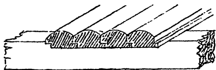
Простильный потолокъ изъ пластинъ.
