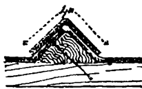
Покрытие толемъ по треугольнымъ брускамъ.
